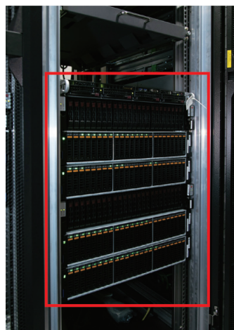
HDD使用時は280TBで7ラックあったが、現在は物理容量490TBがこのサイズ(13U)に
