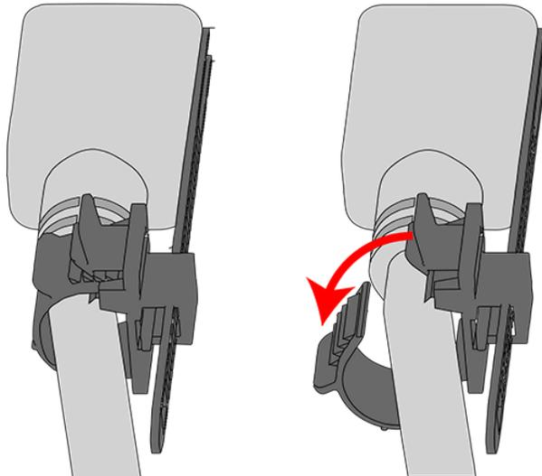
Figure 4: Strap-Style Cable Retention
