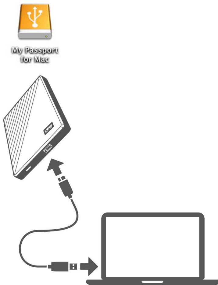
Figure 3 : Connexion du disque My Passport Ultra for Mac
