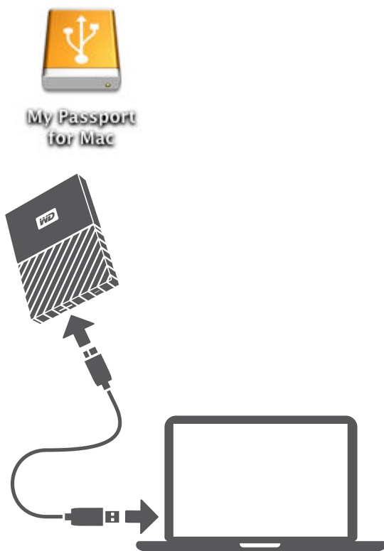
Figure 3 : Connexion du disque dur My Passport
