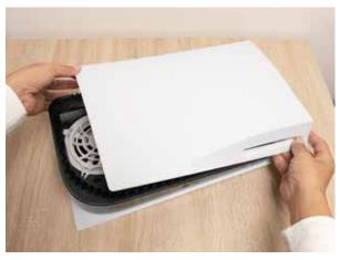
光学ドライブの対角、写真の左奥のコーナーを持ち上げるようにしつつ、反対側の 手で光学ドライブ部分のカバーの下に指を入れ、縦置きしたときの底面に方向へと ずらすとカバーが外れる。
