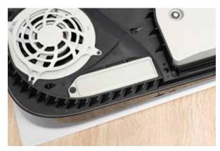
冷却ファンと光学ドライブの脇にある金属の細長いプレートが M.2 スロットを覆うカバーだ。
