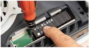
少し浮いた状態にある SSD を軽く押さえながら、ネジで固定する。実質的にはこれで作業は終了。あとは逆の手順でカバーを戻せば設置は完了だ。
