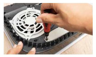
M.2 スロットを覆うカバーを止めているネジを外し、カバーを取り去る。
